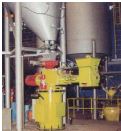
Рис.7. Стационарный смеситель FAT-COMBIMIX ES 2022. Производительность: 22 т/ч
