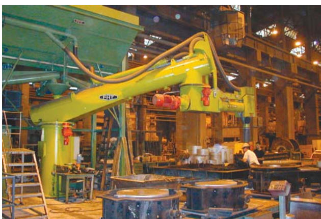
Рис. 4. Стационарный смеситель FAT-COMBIMIX DF 2032 с транспортной лентой для скорости перехода на несколько сортов песка. Производительность 32 т/ч
