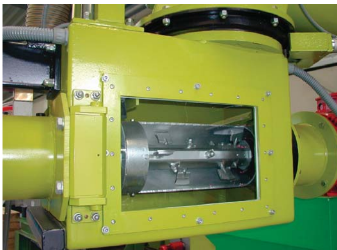
Рис. 12. Камера финишной очистки песка (для улучшения свойств песка)
