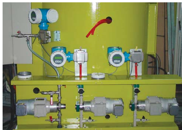
Рис. 14. Насосное устройство с магнитно-индукционным счетчиком (у смесителя DF 2042 3 вида связующего).
