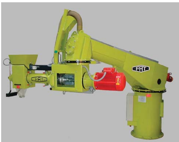
Рис.2. Смеситель непрерывного действия для ХТС-процесса (Альфасет, Фуран)
