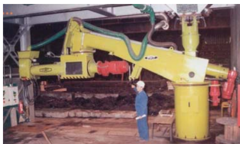
Рис.6. Стационарный смеситель FAT-COMBIMIX DS 2042 с двойным шнеком для быстроты перехода на другой песок. Производительность 42 т/ч
