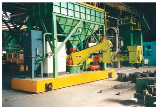
Рис.5. Передвижной смеситель FAT-COMBIMIX DF 2042. Производительность 42 т/ч
