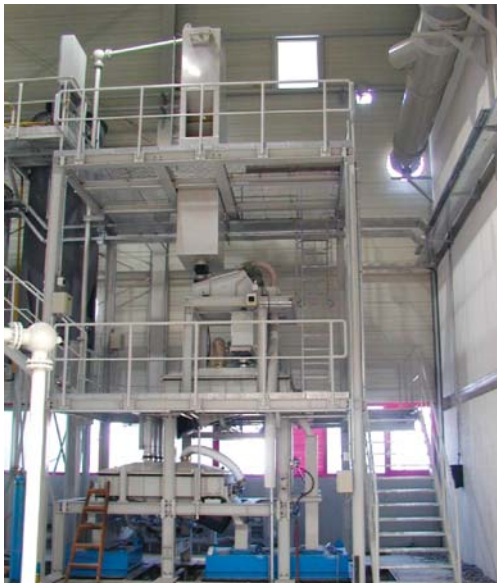
Рис. 17. Установка регенерации и подготовки смеси фирмы FAT вертикального типа (а) и горизонтального типа (б) в условиях реального действующего производства
