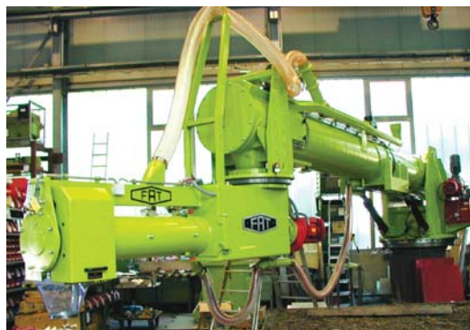
Рис.8. Стационарный смеситель FAT-COMBIMIX DS 2015 с двойным шнеком для быстроты перехода на другой песок. Производительность 15 т/ч
