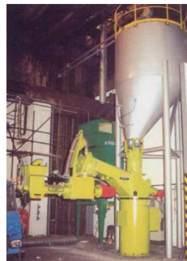
Рис.8. Стационарный смеситель FAT-COMBIMIX DS 2015 с двойным шнеком для быстроты перехода на другой песок. Производительность 15 т/ч
