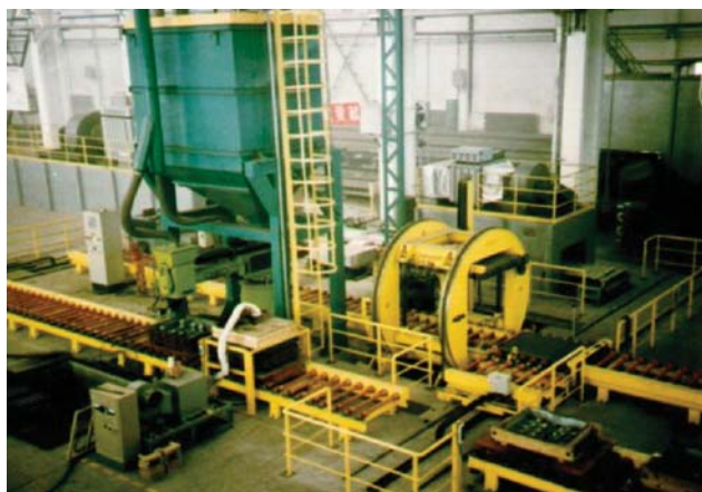
Рис. 16. Кантователь опочных (а) и безопочных форм (б)
