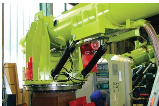
Рис.10. Смесители, регулируемые по высоте. Область применения – изготовление больших форм со сложным рельефом (возвышениями и углублениями) на плацу. Производительность моделей DF – 22–62 т/ч. Конструкция – смеситель с подводящей лентой для нескольких типов песка и быстрого перехода на свежий песок, что обеспечивает быстрый переход к различным видам смесей (например, наполнительной и основной). Смеситель имеет ходовой механизм и бункер со смесью, который пополняется при помощи пневматических устройств несколькими загрузочными станциями
