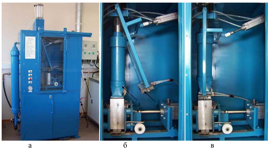
Рис. 15. Лабораторный cold-box автомат: а – общий вид; б – этап надува песчаной смеси; в – этап продувки амином
