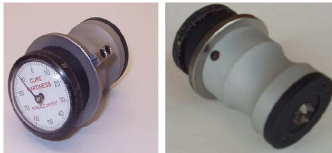
Рис. 12. Тестер для оценки твёрдости стержня цапапаньем
