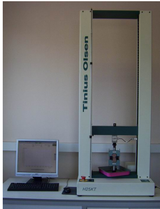
Рис. 11. Современная разрывная машина, применяемая для испытаний стандартных образцов на прочность
