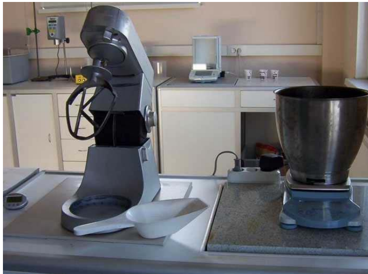
Рис. 10. Лабораторный миксер и чаша, установленная на весы, перед дозированием компонентов ПСС
