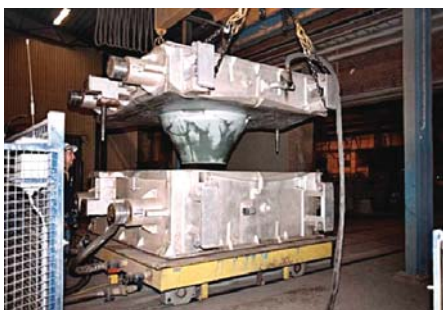
Рис. 7. Сборка формы отливки «конус»
