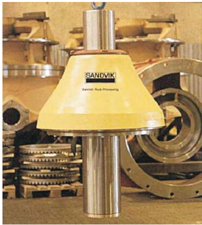
Рис. 16. Первый этап сборки дробилки Hydrocone®
