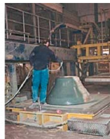
Рис. 15. Окраска формы из безвоздушного распылителя
