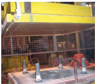
Рис. 12. Подвод и нагрев пленки по V-процессу
