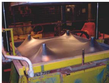
Рис. 13. Наложение пленки на модель
