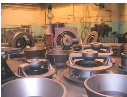
Рис. 9. Крупные отливки после дробе-метной очистки
