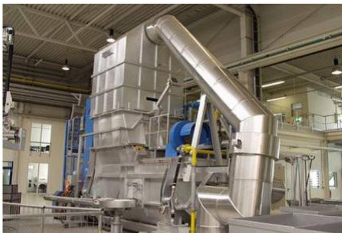
STRIKOMELTER® MH II-T в опрокидываемом исполнении
